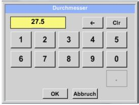
Hier kann der *Innendurchmesser* des Durchflussrohrs eingetragen werden, falls dieser nicht automatisch korrekt eingestellt wurde.
