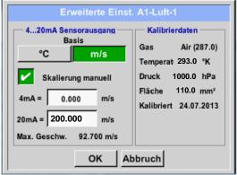
In *Erweiterte Einstellungen* kann man festlegen, ob der 4-20mA-Analogausgang des Sensors auf der Durchflussmenge oder der Geschwindigkeit basieren soll.
