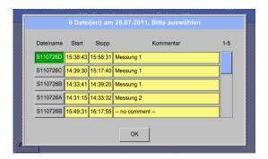
Sind an einem Datum mehrere Messungen aufgezeichnet worden, erscheinen diese nach der Datumsauswahl mit *OK*.
