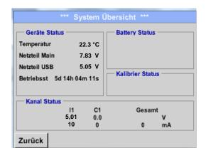
Der Menüpunkt *System-Übersicht* bietet Information über, die anliegenden Spannungen und Ströme der einzelnen und der gesamten *Kanäle*, sowie die Spannungsversorgung der *Netzteile an*.
